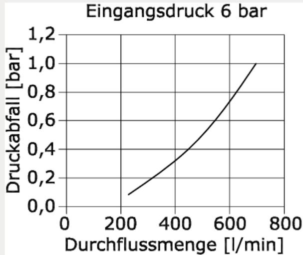
**Durchfluss Diagramm Wasser**
